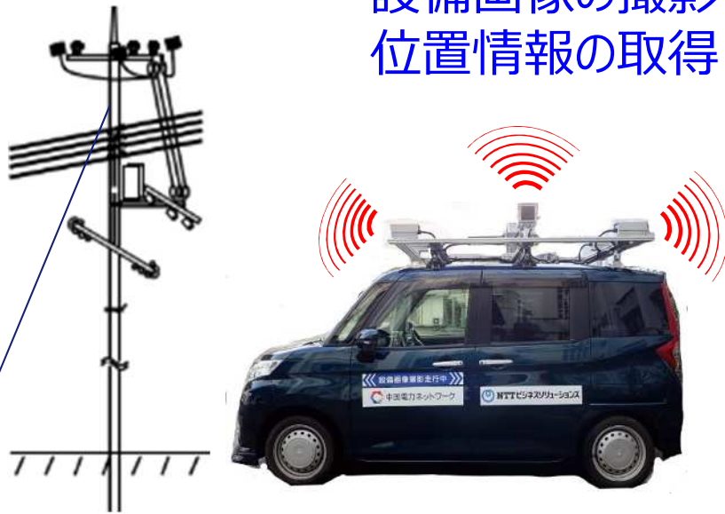
配電設備 カメラを搭載した車両
